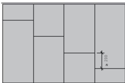
Figure 7 : décalage des plaques du parement
