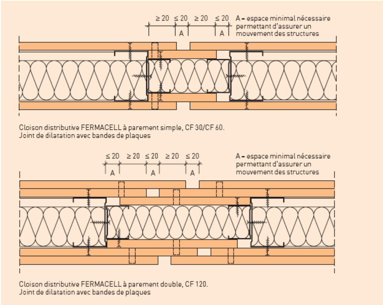
Figure 10 : Joints de dilatation d'une cloison à parement simple (schéma du haut) et à parement double (schéma du bas).
