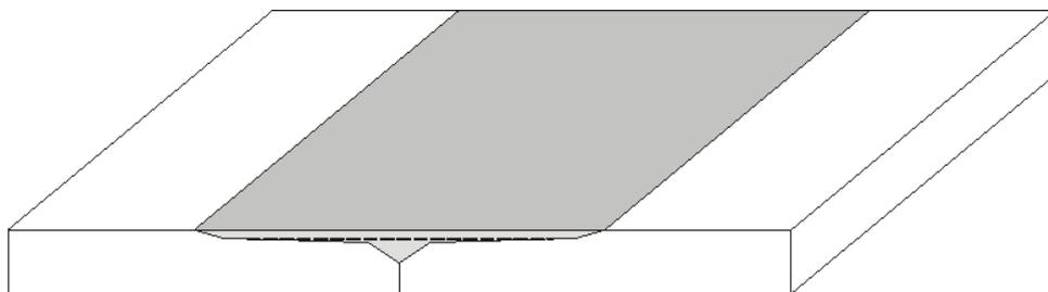
**Figure 5 : application de l'enduit pour joint Fermacell en 2 passes successives.**
