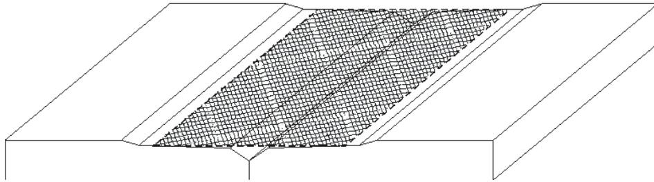
**Figure 4 : Application de la bande de renfort autocollante Fermacell**
