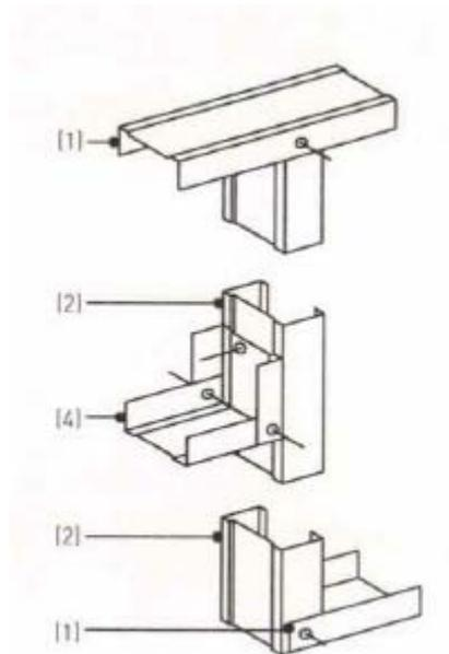
**Figure 6 : Pose d'une traverse pour traitement d'un joint horizontal (plaques BA – cloison à parement simple)**
