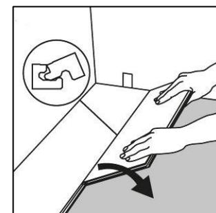
Placez la languette de la première lame de la nouvelle rangée dans la rainure de la lame de la rangée précédente en formant un angle. Poussez vers l'avant et abaissez la lame jusqu'au niveau du sol.
