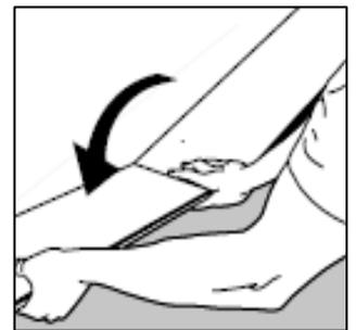
Tracez sur la lame le repère où il faudra scier. Placez la lame face contre sol sur la surface de travail et coupez-la en utilisant une scie.
