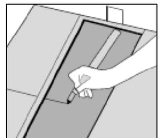
Découpez la dernière lame de la première rangée pour en corriger la longueur. Placez la dernière lame face contre sol, le côté court privé de sa bande de verrouillage vers le mur. La distance par rapport au mur doit être de 5 mm (0,2 po)
